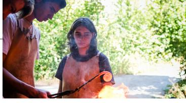
1000°. C'est à cette température que le fer est prêt à être battu. Pour des réalisations demandant des pliures, fentes ou poinçonnages, il faut monter la chauffe pour atteindre 1100 à 1200° et que le métal soit d'une couleur rouge-blanc.
